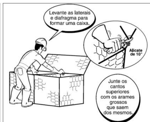
Figura 2: Posicionamento dos painéis laterais e diafragmas
